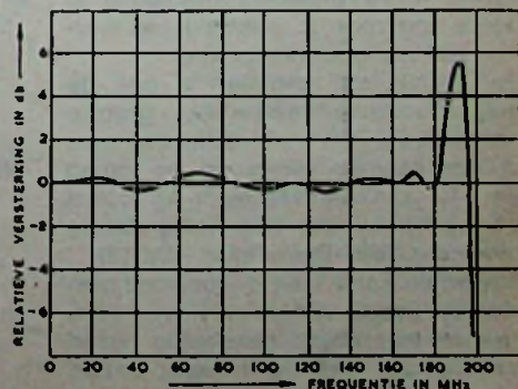
Fig. 3. Versterking van een tweetraps cascade versterker
